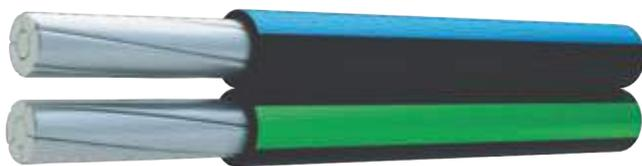
Провод самонесущий с алюминиевыми фазными токопроводящими жилами, с изоляцией из светостабилизированного сшитого полиэтилена (ПЭ), без несущей жилы.
